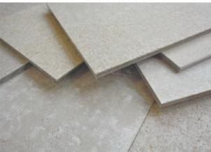
リサイクル内装ボードは、塗装による着色を行わず、セメントの素地そのまま自然な表情を魅せる新しいコンセプトの内装材です。原材料には火力発電所で発生する石炭灰の他、コーヒーショップから出る使用済み紙カップやコーヒー豆かす等、多岐に渡る身近な廃棄物を配合し、セメント素地の表面にコーヒー豆かすが見える状態にすることで、温かみのある室内空間を演出します。
