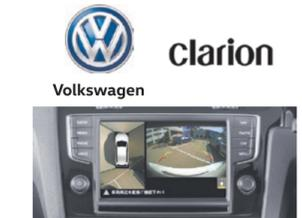
サラウンドアイは、車体に取り付けた4つのカメラにより車両の周囲を真上から見たように表示する駐車支援カメラシステムです。クラリオン独自の画像処理技術で合成することで、車の周辺視界を補助。車庫入れや縦列駐車などのシーンに合わせて複数のカメラパターンを表示することも可能です。近年のドライバーの安全・安心意識の高まりに対応すべく、フォルクスワーゲン グループ ジャパンとクラリオンが共同開発しました。
