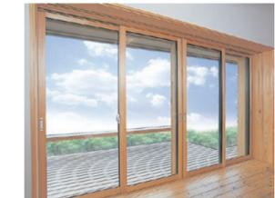
「エピソード杉」は屋外側にアルミ、室内側に無垢の杉を用いた複合サッシ。アルミサッシの機能性と無垢の杉ならではの風合いがあり、自然素材の家によくマッチして家と同様に経年変化が美しい。枠が一般的な木製サッシに比べ太くならず、すっきり見えるのもデザイン上の大きな特徴。組立式の構造の為、室内側の杉は万一傷がついても交換でき、長期間の使用が可能です。
